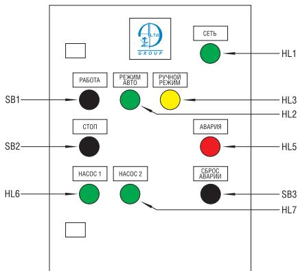
*Рис. 6 Индикация и органы управления шкафа управления*
