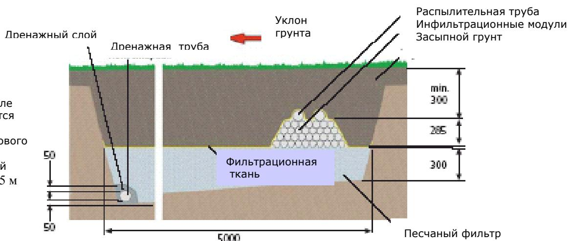
Если на Вашем участке после песчаного фильтра находится морена или глина то минимальная высота грунтового фильтра, состоящего из инфильтрационных модулей составляет 0,9 м, а ширина - 5 м
