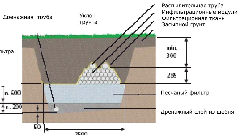
Если на Вашем участке после песчаного фильтра находится песок, супесь или суглинок то минимальная высота грунтового фильтра, состоящего из инфильтрационных модулей, составляет 1,3 м, а ширина до - 2,5 м
