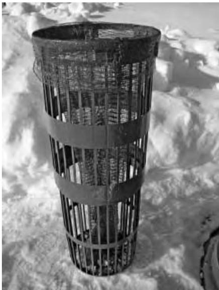
Рис 29. Корзина под мешок для накопления избыточного ила
