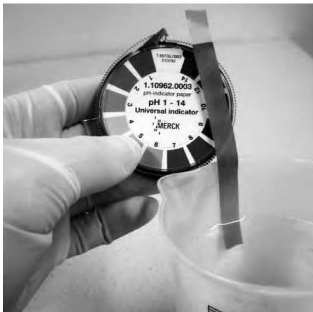
Рис 40. Определение рН сточных вод
