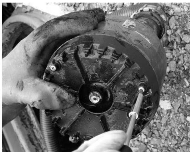
Рис 47. Чистка насосов технологического резервуара
