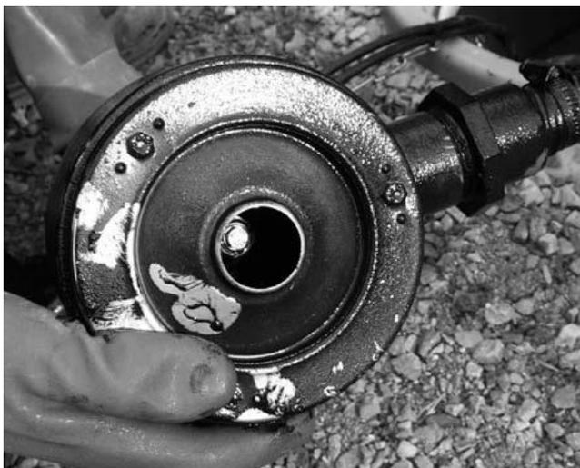
Рис 44 Очищение перекачивающего насоса
