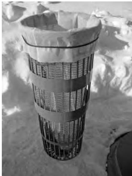
Рис 30. Корзина с мешком для накопления избыточного ила
