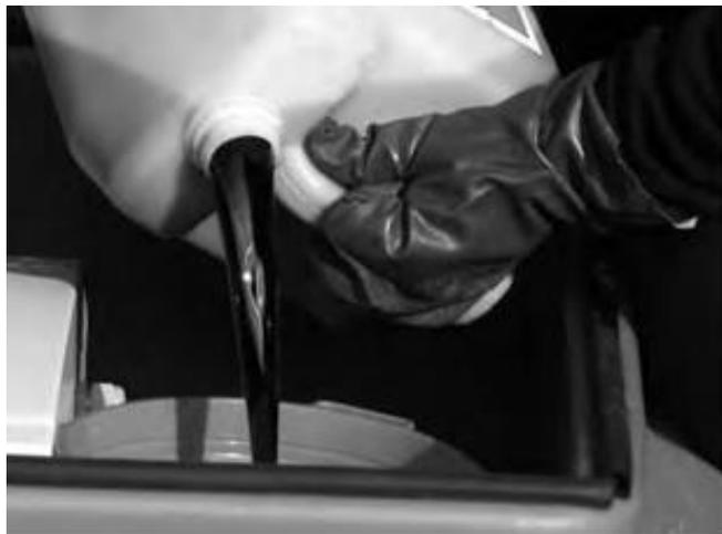
Рис 27. Процедура заполнения резервуара с химическим реагентом
